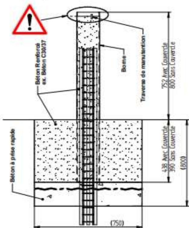
Ⓑ- Enfiler la borne dans le chaînage (s'aider de la traverse de manutention à l'intérieur de la borne) et la faire reposer sur des cales de maintien.
