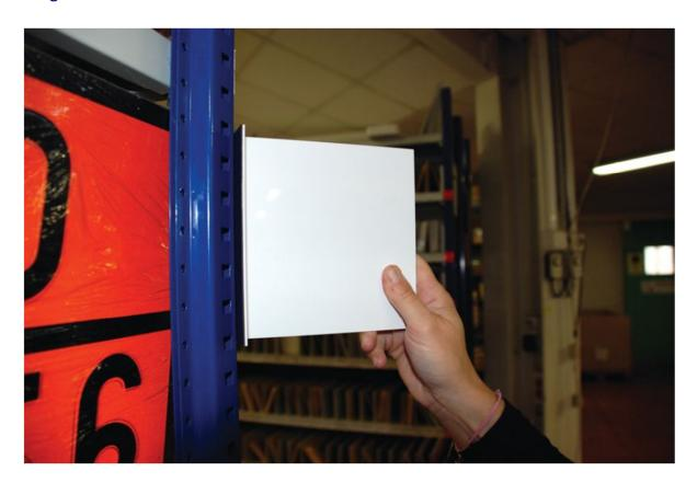
Plaque en PVC blanc de 1,5 mm d'épaisseur avec fixation magnétique sur le retour de 30 mm. Modèle vierge.
