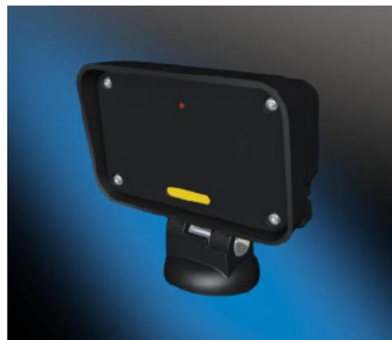
Le radar doit être installé sur un poteau, un mat, ou au sommet d'un panneau au bord de la route à une hauteur comprise entre 2m et 5m du sol. La vue sur le trafic doit être dégagée
